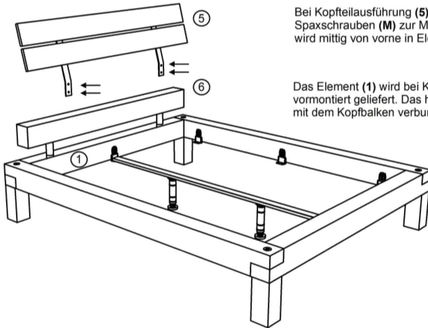
Bei Kopfteilausführung (5) sind vier zusätzliche Spaxschrauben (M) zur Montage beigelegt. Diese wird mittig von vorne in Element (1) geschraubt.
